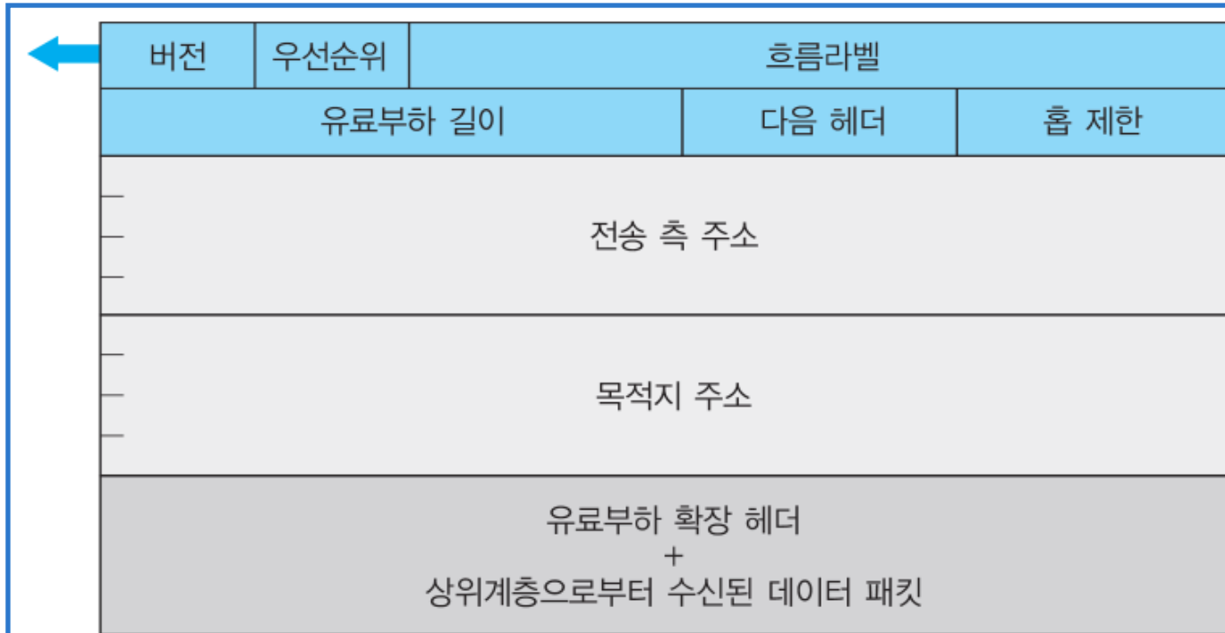
[그림 8-7] IPv6 데이터그램 형식
